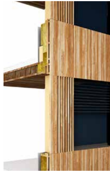
↗ Detailaufnahme eines Knotenpunktes des Holzskelettes
