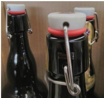
Abbildung 24: Beispiele Bügelverschluss
