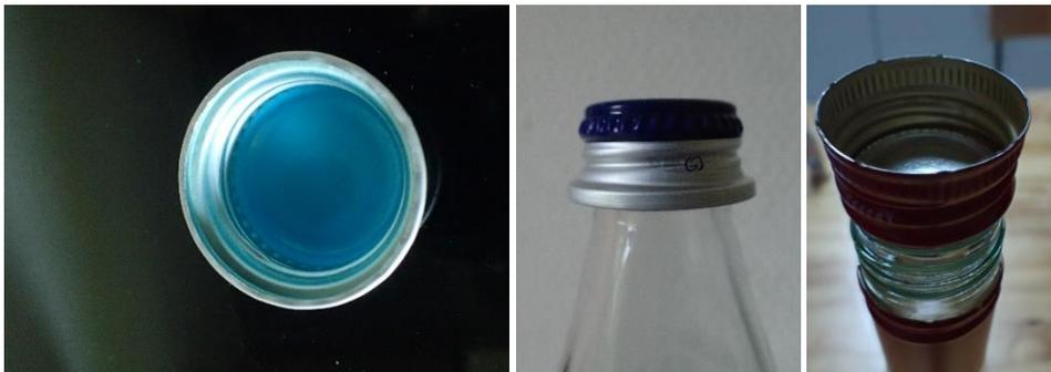
Abbildung 21: Beispiele Schraubverschluss Aluminium
