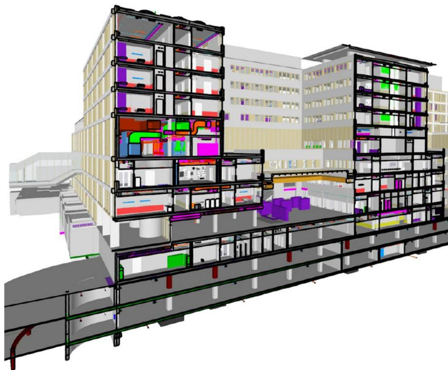
Le Nouveau CHL Centre présente un corps de bâtiment **compact de 113,75 m de côté** sur 113,75 m (dimension axes), sur la base d'une **trame de 1,25 m**.
