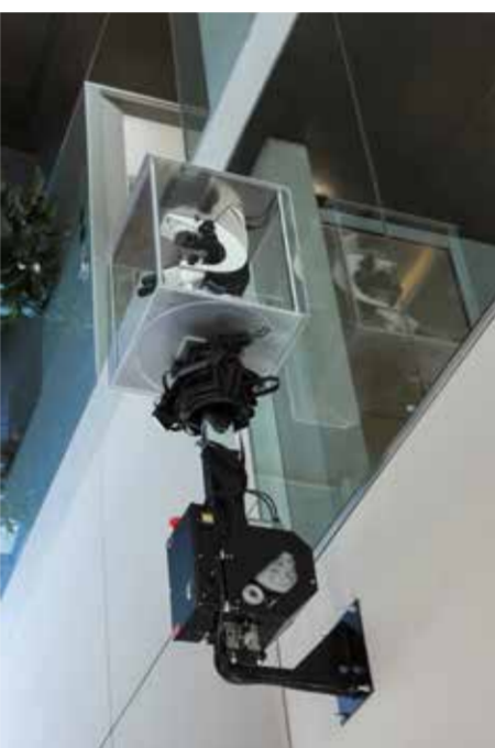
Le microscope est fixé au mur à 4m du sol et ajustable en hauteur par un système de levage
