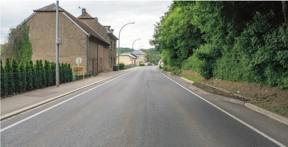
Chaussée avec structuration optique des surfaces latérales - lignes de rive
