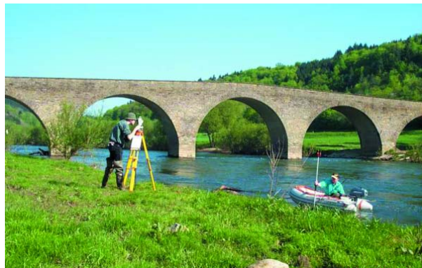
Abbildung 6: Querprofile beschreiben das Relief eines Flussschlauches. Die Vermessung erfolgte mit Hilfe von Nivellements und GPS.
