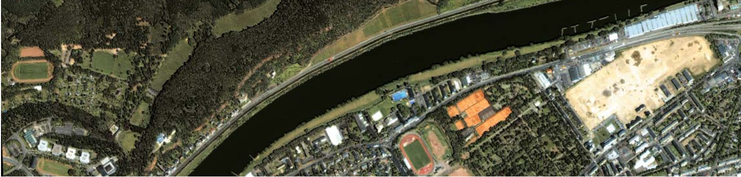
Abb. 13: Ikonos-Satellitenbild. Das ursprüngliche Farbbild hat eine räumliche Auflösung von 4 m, wurde aber durch das 1-m-Schwarzweissbild geschärft. Dadurch sind auch kleine Strukturen noch sichtbar.
