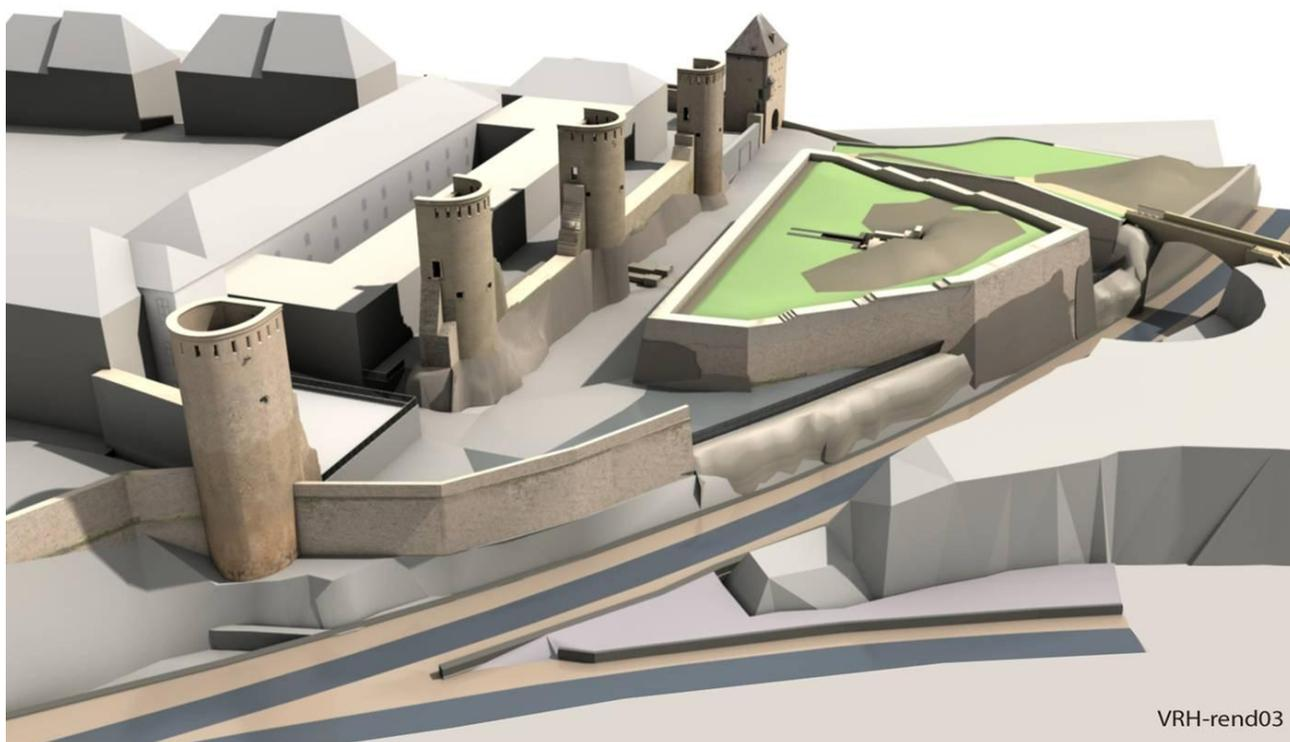
A partir de 2003, le fossé situé devant le mur d'enceinte médiévale fut mis au jour lors d'une première phase d'intervention. Cette excavation permit d'entamer les travaux de rénovation des bâtiments de l'époque Vauban grâce à l'aménagement des accès de chantier puis, par la suite, des accès de secours.
