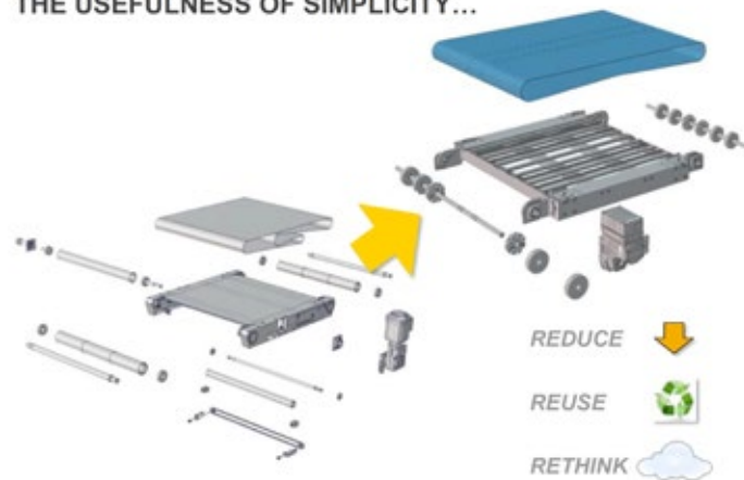
Figure 7 : Illustration du principe de conception modulaire pour un système de transport industriel (Source : Vanderlande).
