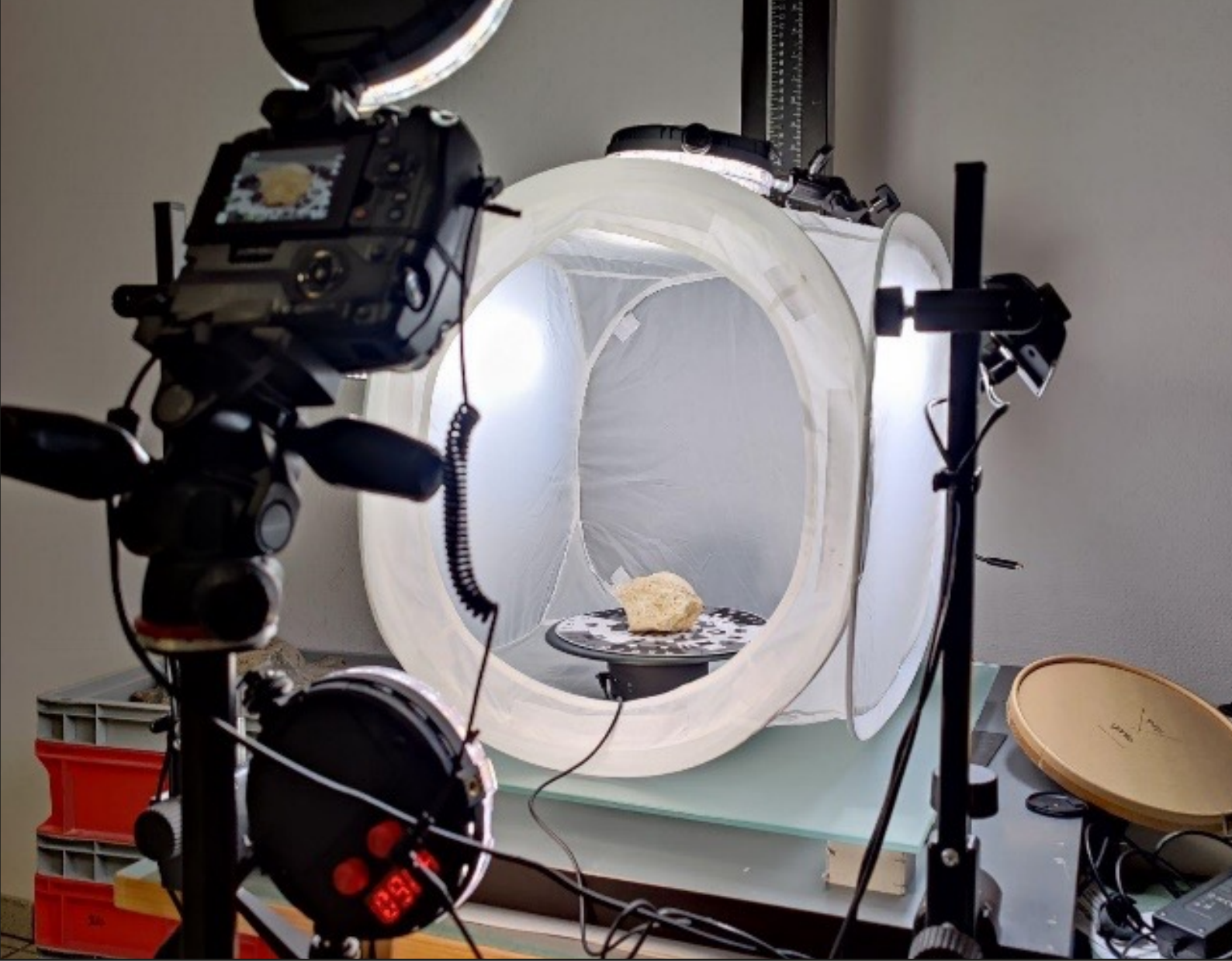
Équipement de photographie utilisant une table tournante automatique pour la pour créer des modèles 3D utilisant la technique photogrammétrie.
