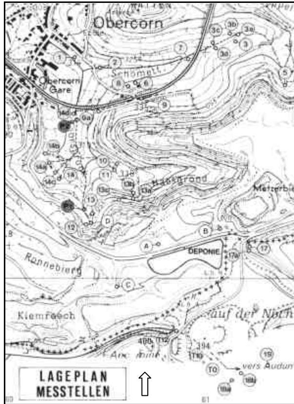
Analyses des eaux de percolation et des eaux de forage dans le cadre des inspections de la décharge Ronnebiere
