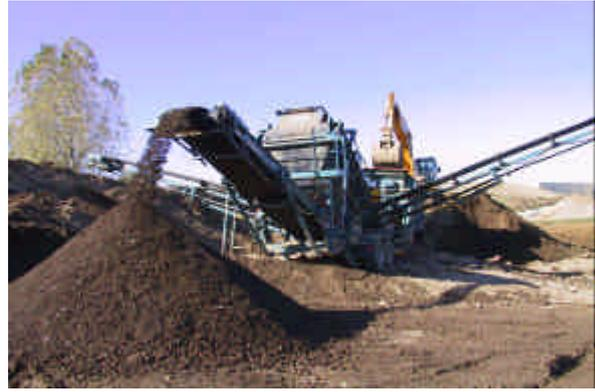
Installation pour le criblage des déchets déposés
