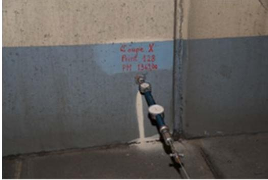
Mesure de déformations dans le tunnel Markusberg
