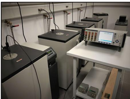
Cellules points fixes, SPRT, Pont de mesure, Résistances
