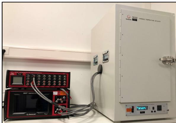
Pont de résistance et enceinte de température
