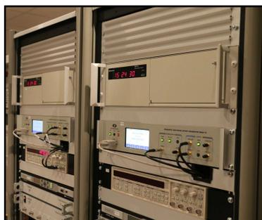
Photo: Échelle de temps nationale UTC(LUX) équipée de deux horloges à jet de Césium 133
