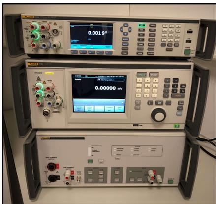
Multimètre et étalonneur universel électrique de référence
