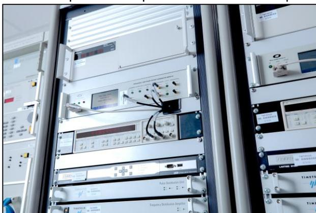
Photo: Échelle de temps nationale UTC(LUX) équipée de deux horloges à jet de Césium 133
