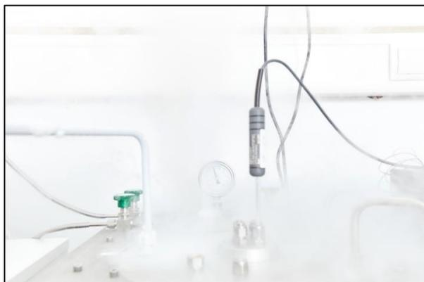
Mise en œuvre de la cellule de point triple de l'Argon
