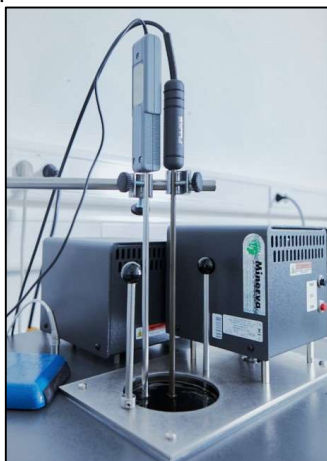
Photo: Étalonnage par comparaison dans un bain
