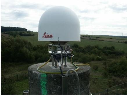
Ce remplacement physique des antennes a été opéré en collaboration avec CREOS qui assure les ressources et le matériel nécessaire pour garantir l'accès aux antennes. Pour la nouvelle station à Echternach, un nivellement de précision a été effectué afin de déterminer la hauteur NG précise de cet équipement.
