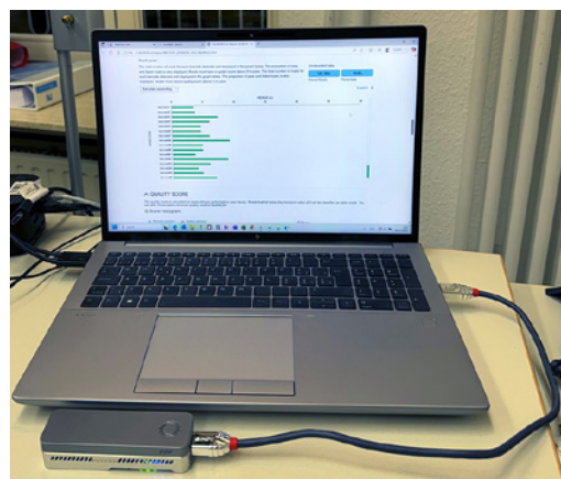
Miniaturisations des séquenceurs nouvelle génération. Séquenceur MinION Oxford Nanopore® attaché à un ordinateur portable
